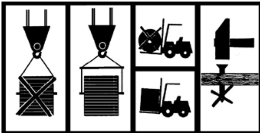
Максимальные размеры: диаметр шейки 4 м, ширина 2,4 м, масса барабана с кабелем 25 тонн. Минимальный диаметр шейки кабеля должен быть не менее  $15 \cdot D$  кабеля. При погрузке и выгрузке барабанов с кабелем необходимо использовать грузозахватное устройство (траверсу), использование которого позволит предохранить кабель при погрузке и выгрузке.
