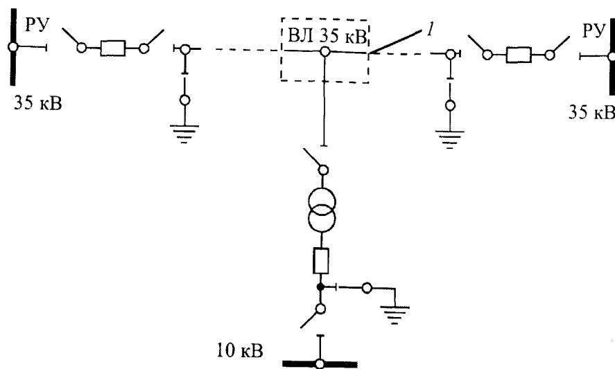
Рис. 6.1. Пример установки заземления на ВЛ 35 кВ с подстанцией на ответвлении в соответствии с п. 3.6.1 настоящих Правил (заземления на рабочем месте не показаны):
