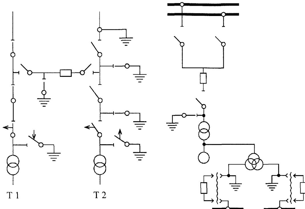
Рис. 4. Подстанция по схеме мостика.
