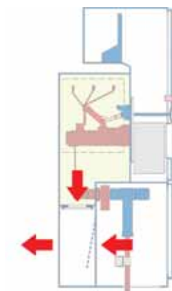
Рисунок 7.15.2: Разгрузка давления в помещение РУ, ячейка 400 мм
