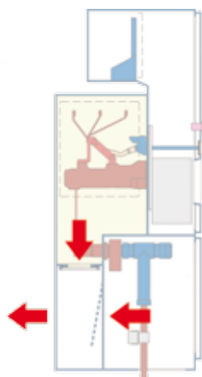
Рис. 6.14.2. Декомпрессия в помещение распределительного устройства, ширина ячейки 400 мм
