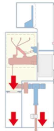
Рис. 6.14.1. Декомпрессия в кабельный колодец, ширина ячейки 400 мм
