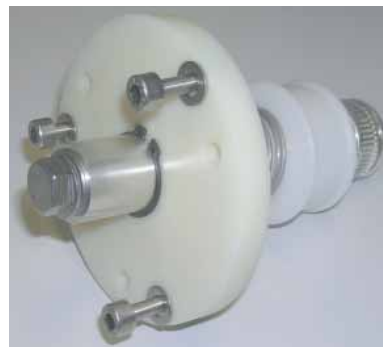
Рис. 7.6.3. Штекер для токовых испытаний
